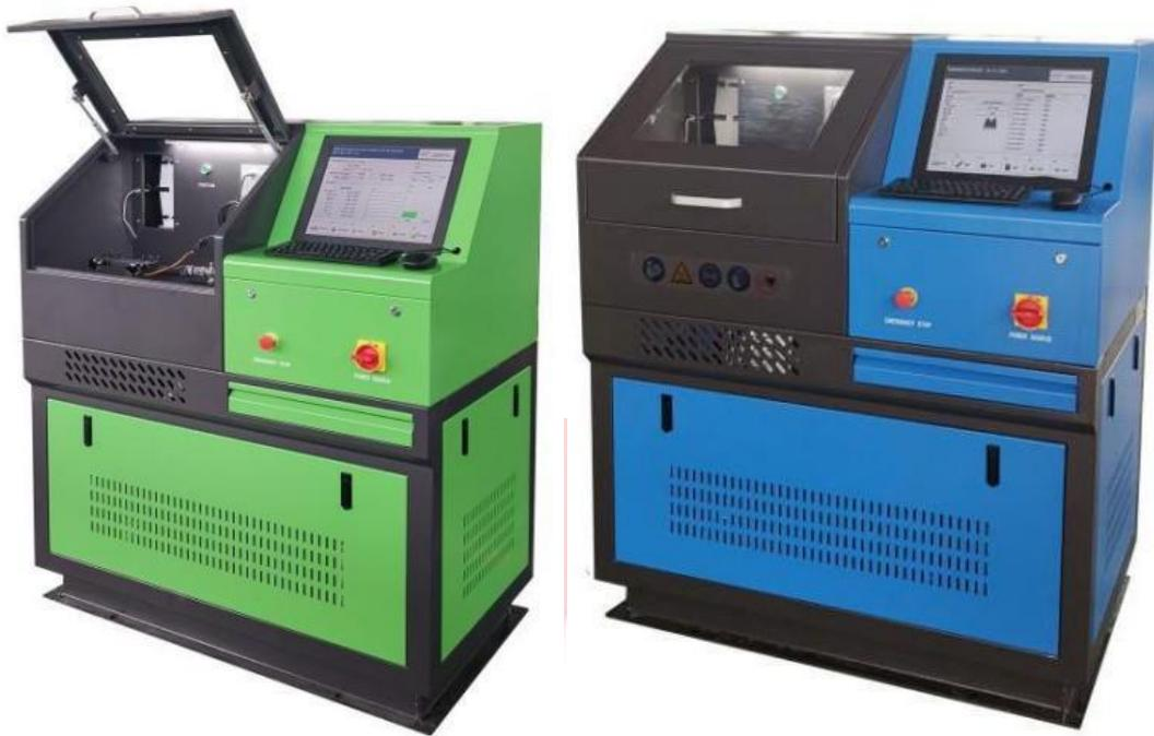
El banco de pruebas NTS300 es nuestro último dispositivo especial de investigación independiente para probar el rendimiento del inyector common rail de alta presión, controlado por computadora industrial, sistema operativo windows.
